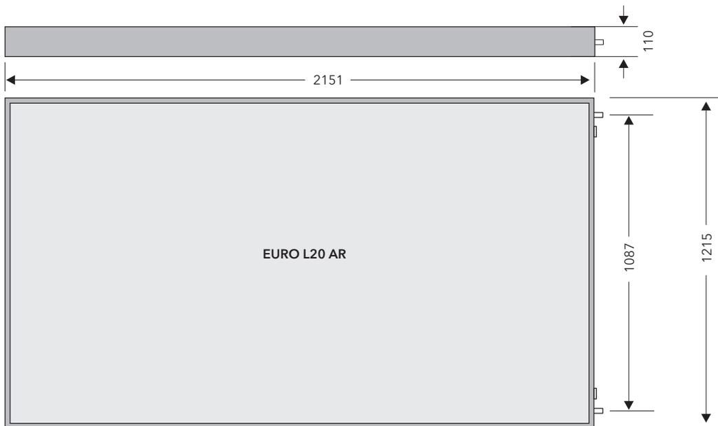
Bild 5 Abmessungen (mm)
